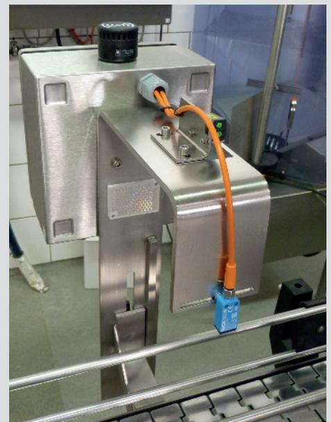
CapCo steht für 'Cap Count & Control' - einen Flaschenzähler mit Verschluss-Kontrolle, der bei Lohnabfüllbetrieben und selbstabfüllenden Winzern Einsatz findet.
